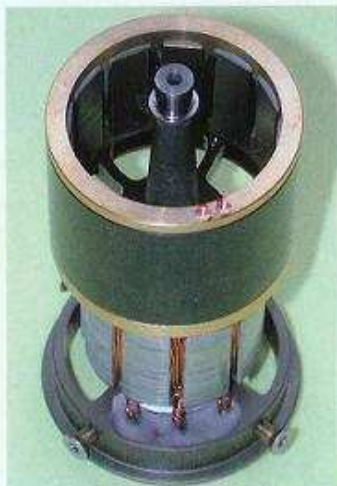
Der zwölfpolige Rotor ist dynamisch gewuchtet; erkennbar an den Bohrungen auf dem Messingring, der die Magnete seitlich sichert
