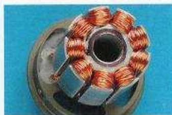
Kein LRK, sondern ein klassisch bewickelter Stator mit neun Nuten
