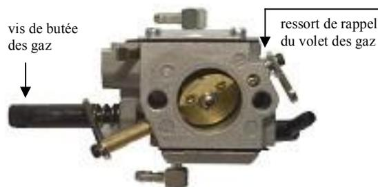
Si la tringlerie de commande des gaz n'est pas équipée d'un élément flexible, il N'EST PAS recommandé d'enlever le ressort de rappel du volet des gaz. Autrement, les vibrations du moteur vont détériorer rapidement l'axe du volet des gaz, ce qui va rapidement perturber le fonctionnement du carburateur.
